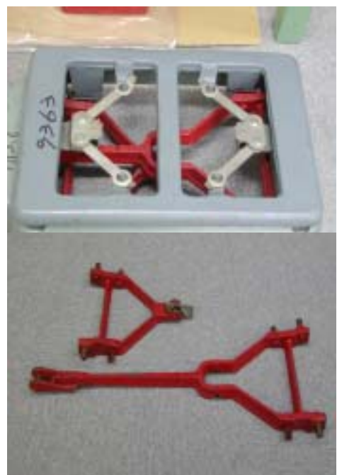
図2 台はかりの構造
